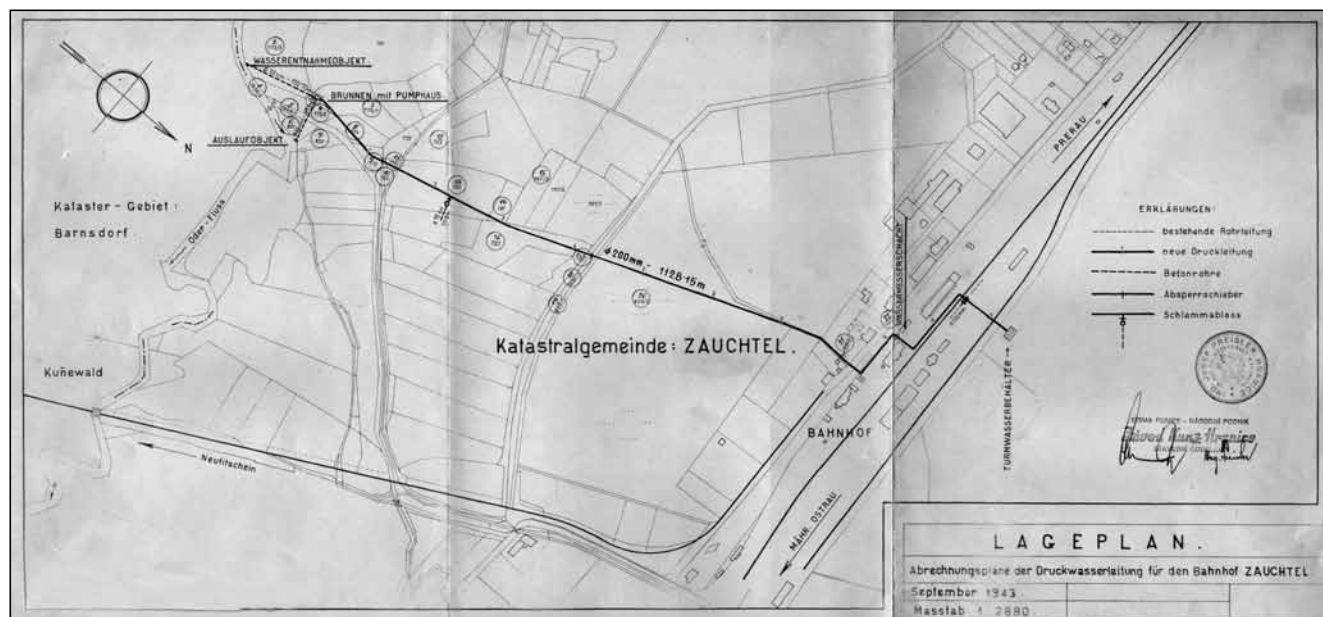
Plán trasy potrubí z vodárny na nádraží (září 1943)
